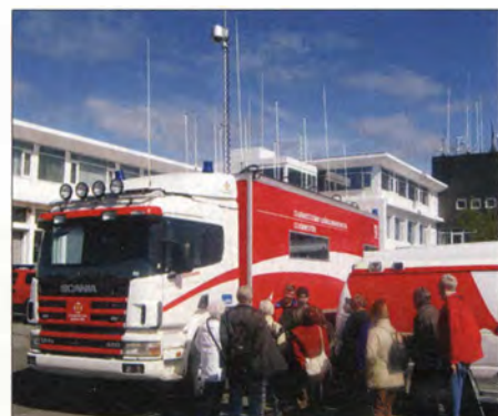
Mobiles TETRA-Kontrollzentrum mit 18 Antennen
