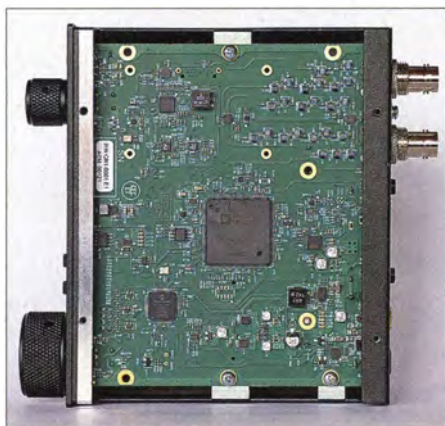
Bild 4: Die komplette Empfängerelektronik ist auf einer einzelnen Platine aufgebaut.
