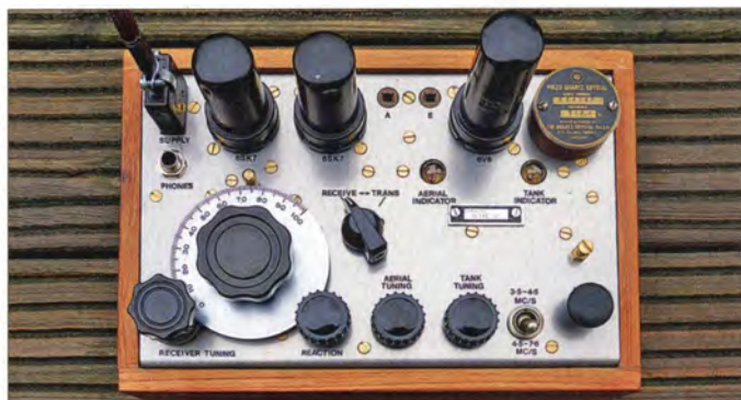
Bild 1: Agentenfunkgerät Mk. VII Radio Set, bekannt als Paraset
