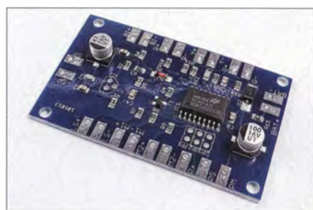
Bild 3: Die teilbestückte Platine mit Lötstopplack eignet sich auch für Lötanfänger.
