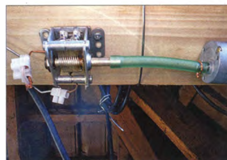
Bild 3: Drehkondensator mit Motor am Fußpunkt der Antenne (Standrohr) im Dachboden
