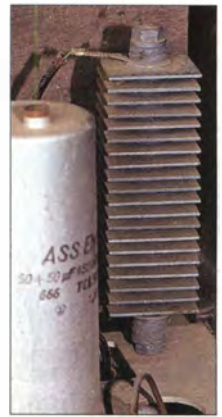
Bild 16: Diese Selengleichrichter-Säule (rechts neben dem Elektrolytkondensator) war für die Gleichrichtung der Anodenspannung in einem Allstromgerät vorgesehen. Fotos: DL7KWB (4), DK7ZB (1)
