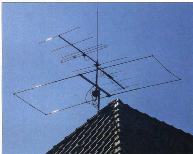
Bild 1: Antennenanlage von DL7BK; das Drehrohr des Rotors trägt zunächst eine Moxon-Richtantenne für 10 m und 11 m. Dann folgen Yagi-Antennen für UKW-Hörfunk (vorn) und 2 m/70 cm. Die darüber angebrachte CB-Whip-Antenne wird nur im 11-m-Band genutzt. Ein ferngesteuerter Drehkondensator am Mastfuß bringt das gesamte Gebilde zwischen 14 MHz und 30 MHz auf Resonanz.
