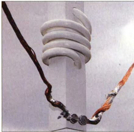
Bild 5: Detailansicht der aus 75-Ω-Koaxialkabel als Drossel aufgewickelten λ/4-Transformationsleitung
