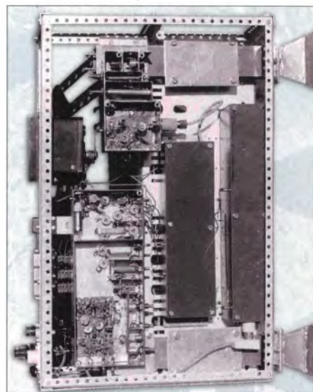
5,6-GHz-Station von DM2DIN, rechts die zwei Hornstrahler Foto und Scans: DB6NT (1), DM2DIN
