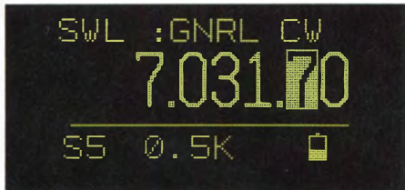
Bild 6: Im Empfangsbetrieb zeigt das Display die Frequenz auf 10 Hz genau und rechts darüber die Sendart. In der Zeile darunter sind die relative Empfangsfeldstärke, die Filterbandbreite und der Ladestand des eingebauten Akkumulators ablesbar.
