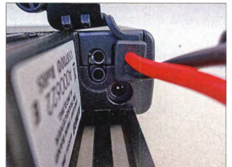
Bild 8: Bei Nichtgebrauch abgedeckte Klinkenbuchsen für externe Lautsprecher und eine Hohlstiftbuchse für eine optionale Zündungserkennung
