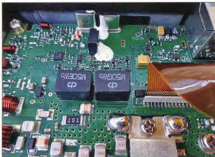
Bild 6: Detailansicht der getrennten Quarz- und Keramikfilter für einen der Empfängerzüge
