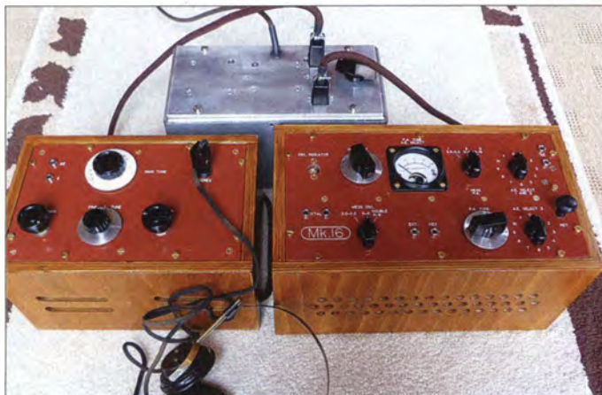
Bild 3: Größere Agentenfunkanlage, englisches Mk 16 ; links der Empfänger, ein 1-V-1-Audion, rechts der Sender (6V6-Quarzoszillator, 6L6-Endröhre, Verdopplerfunktion), hinten das Netzteil
