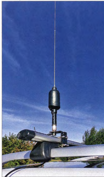
Bild 3: 20-m-Monobandstrahler; die Länge des geteilten Stabes beträgt etwa 120 cm, er ist zur Abstimmung teleskopartig verschiebbar.
