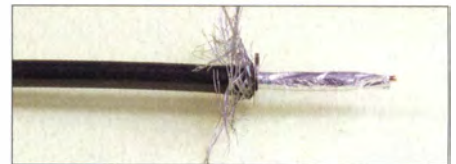
Bild 2: Die Massehülse nun zwischen Außengeflecht und Aluminiumfolie drücken, dabei evtl. mit Steck- oder Ringschlüssel, Röhren o. Ä. von vorn nachhelfen.
