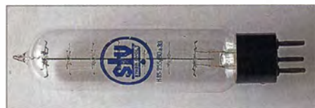
Bild 12: Eisen-Wasserstoff-Widerstand: Erkennbar ist der aufgespannte Eisendraht im Glaskolben. Dieser befindet sich in einer Wasserstoffatmosphäre.
