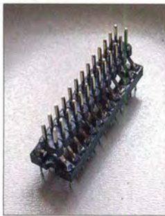
Bild 3: Selbst gefertigter Adapter zum Verbinden der GPIO-Schnittstelle eines Raspberry Pi und des Steckbretts über ein Flachbandkabel
