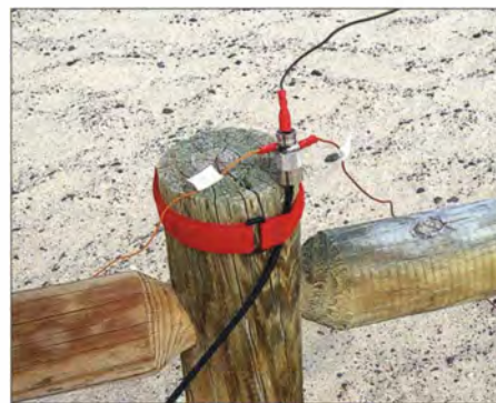
Bild 6: Groundplane-Antenne; Detail der minimalistischen Einspeisung
