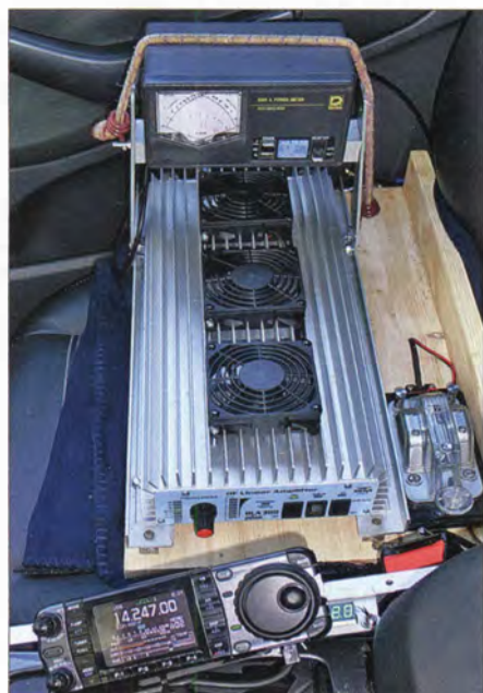
Bild 1: Unmittelbar rechts neben dem Fahrersitz befindet sich das IC-7000-Bedienteil, auf dem Beifahrersitz sind Endstufe und SWV-Messgerät auf einem Holzbrett untergebracht.
