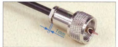
Bild 4: Verschlusschraube von Hand anziehen, mit Maulschlüsseln 11 mm und 12 mm festziehen (1 mm Spalt lassen), Innenleiter bündig abschneiden und anlöten.
