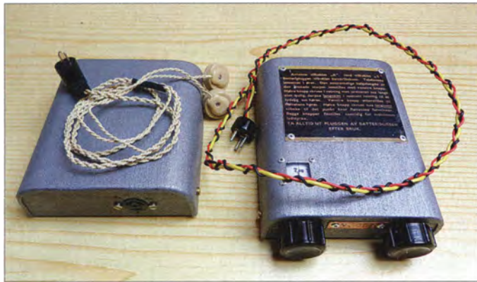
Bild 2: Dreiröhren-Batterieempfänger 31/1 Sweetheart ; 0-V-2-Audion mit drei 1T4-Batterieröhren, entwickelt vom Norweger Willy Simonsen 1942 im englischen Exil. Solche Funkanlagen wurden per Fallschirm für Widerstandskämpfer abgeworfen.
