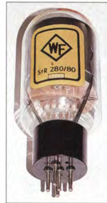
Bild 17: Stabilisatorröhre vom Typ StS 280/80 mit drei Glimmladungsstrecken. Diese Röhre kann eine Spannung von 280 V und einen maximalen Querstrom von 80 mA über einen Vorwiderstand bereitstellen.
