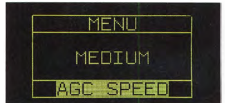
Bild 8: Die Abfallzeit der AGC ist dreistufig wählbar.
