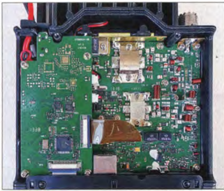
Bild 5: Blick ins Innere: Gut erkennbar sind die Abschirmbleche der mittig montierten Treiber- und Endstufentransistoren.
