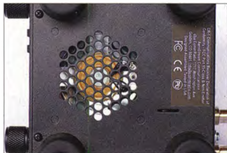
Bild 3: Der eingebaute Lautsprecher strahlt nach unten.
