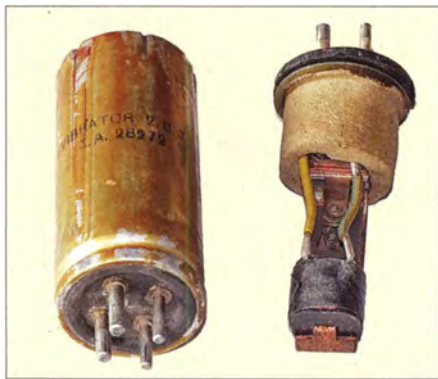
Bild 10: Äußerlich ähnelt diese Zerhackerpatrone einem Elektrolytkondensator. Wegen des hohen Verschleißes dieses Bauteils waren diese für einen schnellen Wechsel steckbar ausgeführt. Rechts im Bild ist das Innenleben mit der Treiberspule zu sehen; die Umschaltkontakte sieht man hier nicht.
