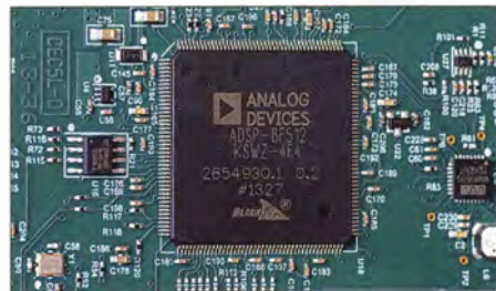
Bild 5: Für Demodulation und Bandbreitenfilter ist ein DSP zuständig.
