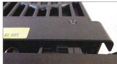
Bild 4: Das Bedienteil ist für die Über-Kopf-Montage über vier Rastnasen auch um 180° gedreht einschiebbar.
