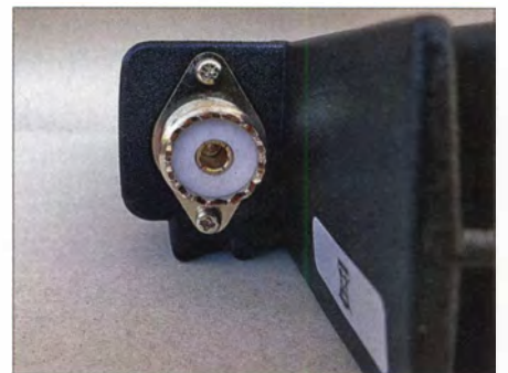
Bild 9: Die PL-Buchse als Antennenanschluss für beide Bänder
